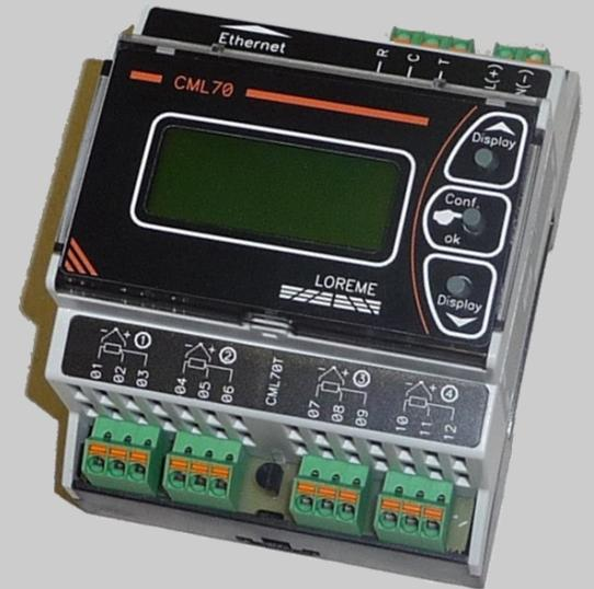
Le CML70 est une centrale d'acquisition compacte quatre voies pour les applications exigeantes en terme de précision et de sécurité fonctionnelle , l'isolation complète du produit assure une indépendance totale de chaque mesure.
